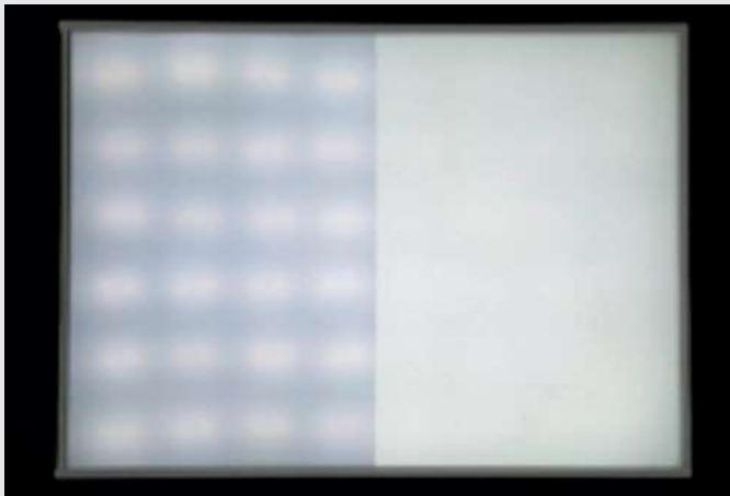
Abb. 2: Vergleich unzureichender Streuung mit sichtbaren LEDs (links) mit optimierter Streuung bei PLEXIGLAS® LED Black & White 9H001 (rechts)
